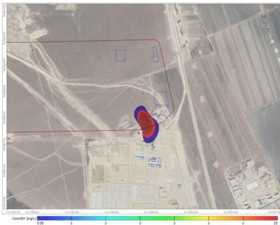
图 7.5.4-1 (c) 风险状况下甲醇（耗氧量表征）运移 7300d 预测结果示意图
