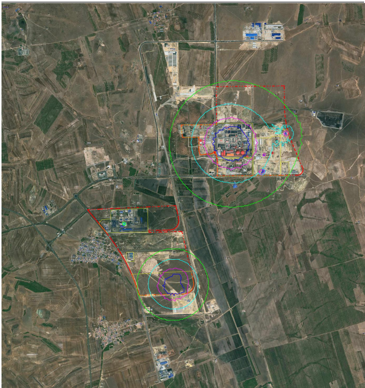
图 2.2-1 GB 36894-2018 实施后园区新建、改建、扩建危险化学品生产装置和储存设施个人风险等值曲线（深蓝色曲线为 1 \times 10^{-5} 次/年个人风险等值线，紫红曲线为 3 \times 10^{-6} 次/年个人风险等值线，水蓝色曲线为 1 \times 10^{-6} 次/年个人风险等值线，绿色曲线为 3 \times 10^{-7} 次/年个人风险等值线）
